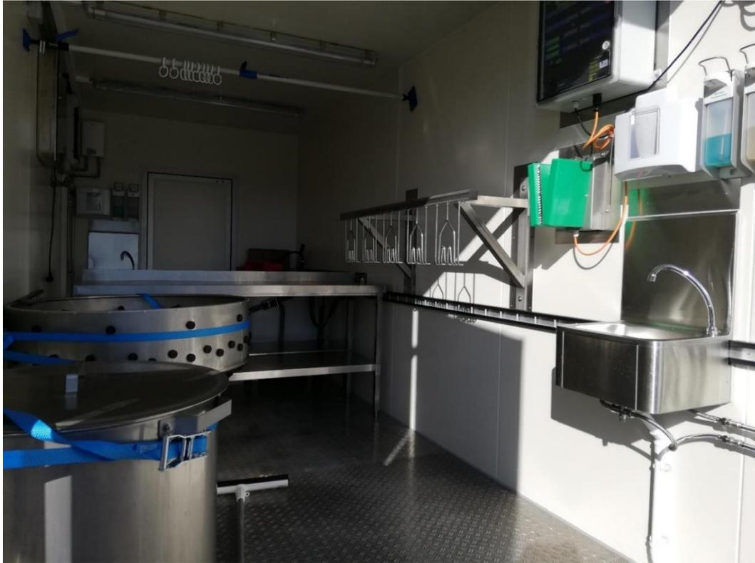
Abb. 2: Geflügelschlachtmobil, gereinigt und desinfiziert, mit Transportfixierung des Brühkessels und der Rupfmaschine an der linken Seite. Die Abtrennung zwischen reiner (hinten) und unreiner Seite (vorne) ist für das Foto entfernt worden. Rechts an der Wand befindet sich das Handwaschbecken der unreinen Seite und die Elektrobetäubungsanlage.
