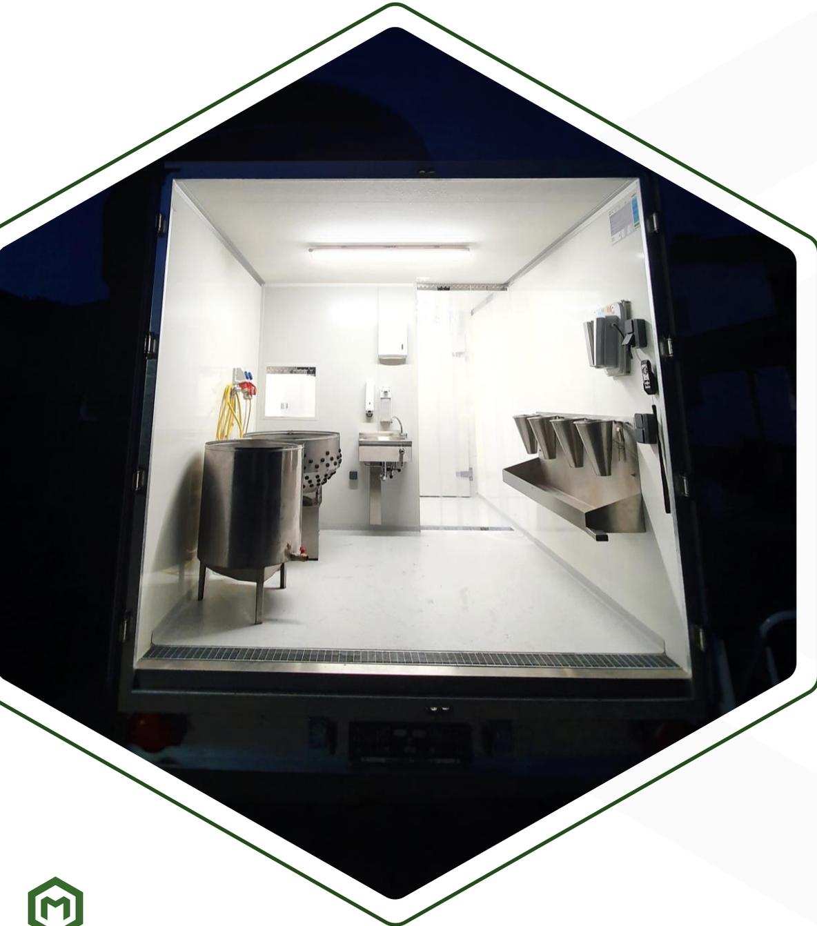
Alle Leitungen und Rohre sind "unterputz" verlegt. Somit entsteht eine glatte Oberfläche im Schlachtmobil für die leichte Reinigung und führt zu geringerer Belastung.
